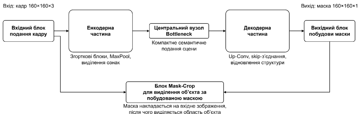
Рисунок 2 – Структура моделі оброблення відеопотоку на основі згорткової нейронної мережі encoder–decoder
