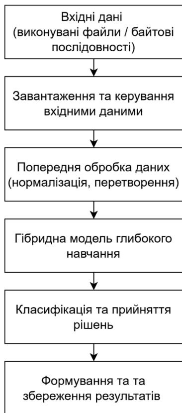
Рисунок 1 – Структурна схема програмного модуля виявлення шкідливого програмного забезпечення
