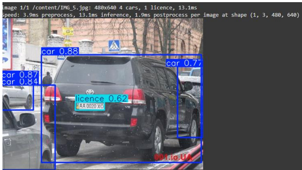
Рисунок 4 Результат застосування моделі YOLOv11 при розпізнаванні на зображеннях автомобілів та їх номерних знаків
